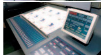
です。この印刷機は、プリプレスからの絵柄面積率データをもとに印刷する絵柄に合わせて必要なインキ量を設定するシステム(ハイパーシステム)により印刷の立ち上がりや早め、損紙の発生を抑えることができる装置や印刷版を印刷ユニットにセットするだけで、排版から版装着までを全自動で行うことができる全自動版交換装置(フルAPC)を備えています。また、生産実績の記録・集計やグラフ化を行う生産実績管理機能や、過去の履歴から必要なメンテナンスを通知するメンテナンス管理機能、さらに印刷トラブルの事前回避に役立つトラブル履歴の管理機能など、さまざまな管理機能を備え、カタログ等の短納期・大ロットの印刷物に活躍しています。
