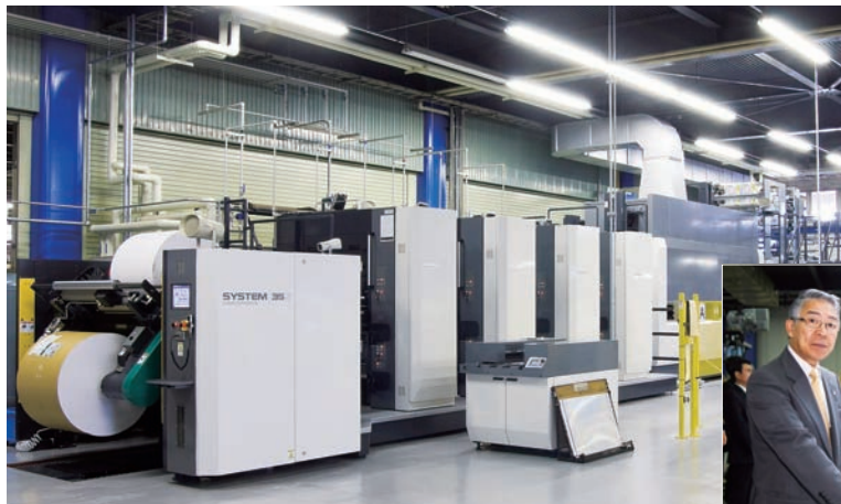
●B縦半裁オフセット輪転印刷機「SYSTEM 35S」
