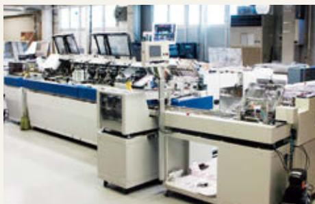
▲新たに導入された封入封緘機「EXTRUST (2号機)」
