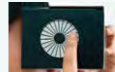
円形部分が導電性インクで印刷された「Touch Interface Module」
