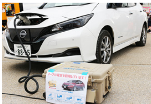
会場で使用する電気をEV車から給電
