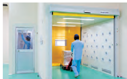
エアシャワーで衛生管理した第5工場2階
